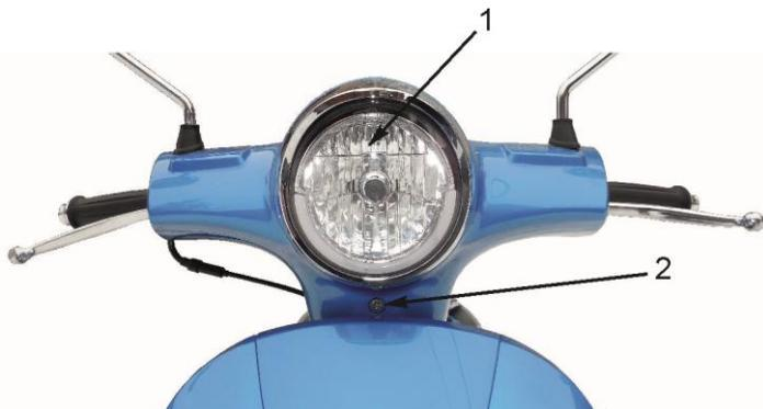
1 – фара; 2 – винт для регулировки ближнего света фары.
