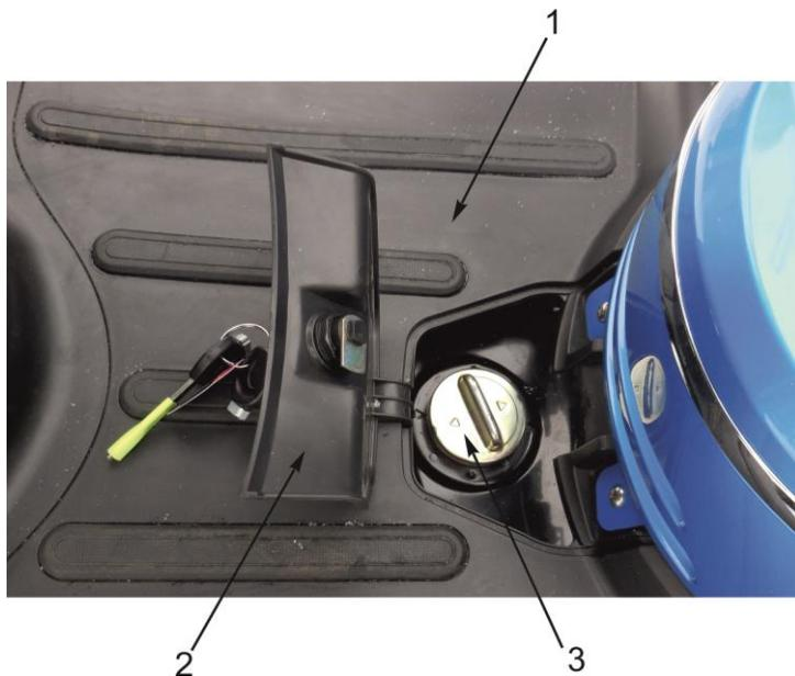
1 – площадка для ног водителя; 2 – лючок заливной горловины топливного бака; 3 – пробка топливного бака.
