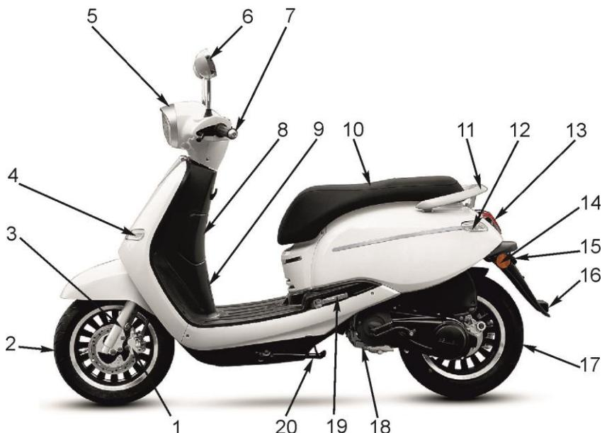
1 – тормоз передний; 2 – колесо переднее; 3 – вилка передняя; 4 – указатель поворота передний; 5 – фара; 6 – зеркало заднего вида; 7 – руль; 8 – крышка переднего багажного отсека «бардачка»; 9 – лючок для считывания идентификационного номера; 10 – седло; 11 – рукоятка; 12 – указатель поворота задний; 13 – стоп-сигнал; 14 – светоотражатель боковой; 15 – фонарь освещения номерного знака; 16 – светоотражатель задний; 17 – колесо заднее; 18 – двигатель; 19 – подножка пассажира; 20 – боковой упор.
